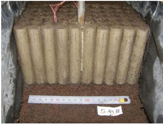
写真-1 地震動加振後の改良柱体
