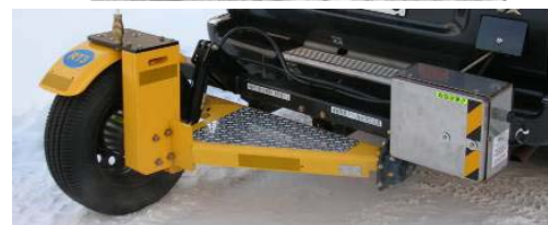
写真-6 連続路面すべり抵抗値測定装置 (CFT) (上：全景、下：測定輪)
