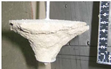
図3-8 アンカー体の引抜き試験後の様子
