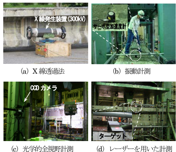
写真-3.5.1 今回実施した非破壊検査手法
