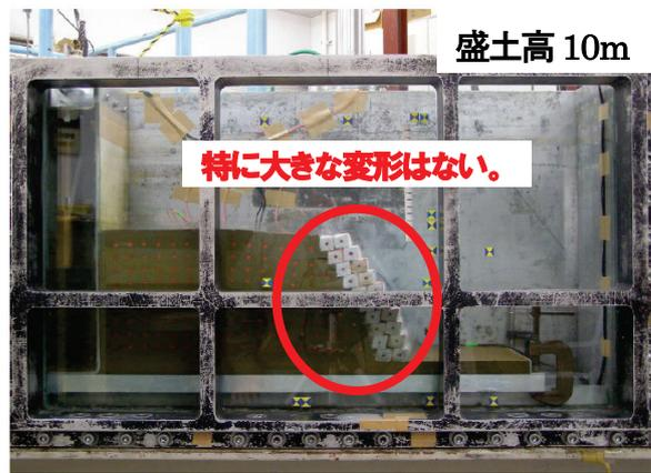
写真3-2: 実験後の盛土崩壊の状況
