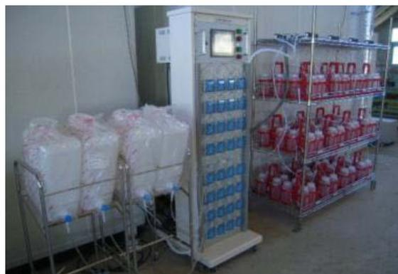
図-10 重金属等促進溶出試験装置(人工降雨装置貯留槽部、制御部、自動採水装置)
