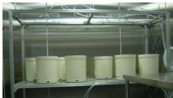
図-9 重金属等促進溶出試験装置(土研式雨水曝露試験装置、人工降雨装置噴霧部)
