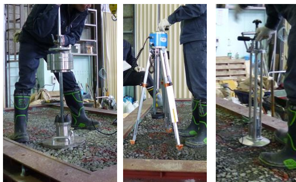
写真-2.6 測定状況 (左: 小型 FWD、中央: キャスポル、右: 衝撃加速度試験機)
