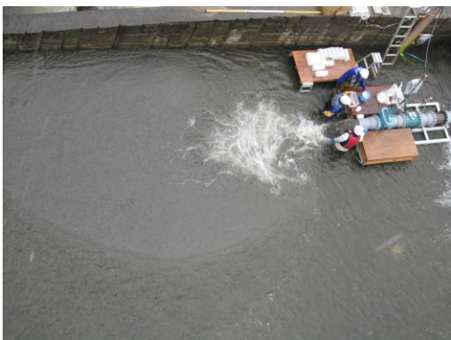
図-151 実験時排砂状況 (ケース4)
