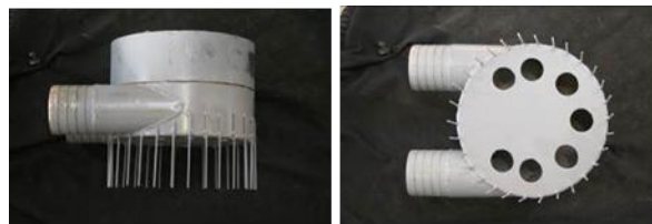
a) 排砂管吸引部(左:側面、右:底面)
