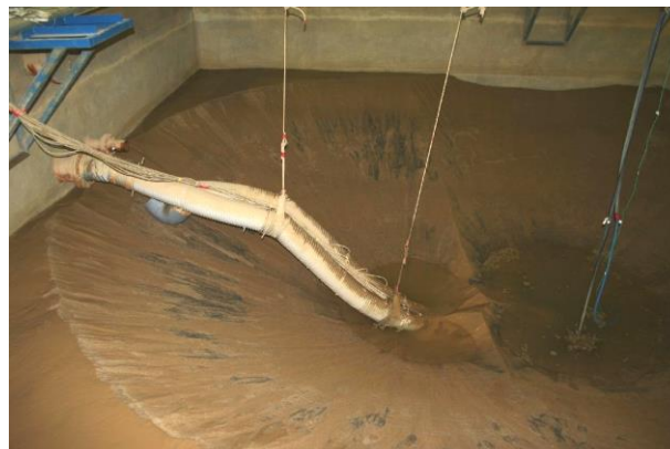
図-5 ケース1の排砂管設置と排砂後の状況
