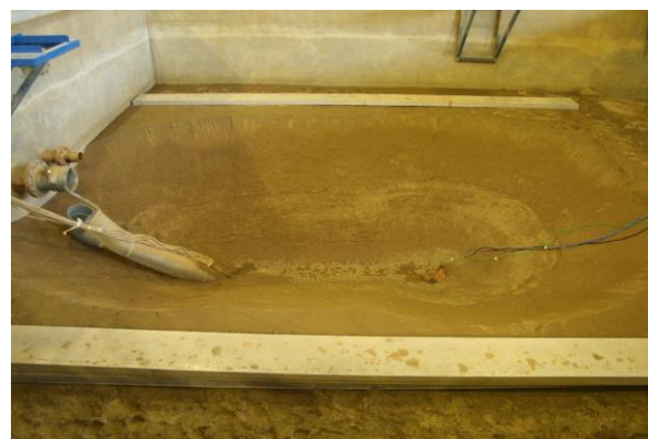
図-5 ケース1の排砂管設置と排砂後の状況
