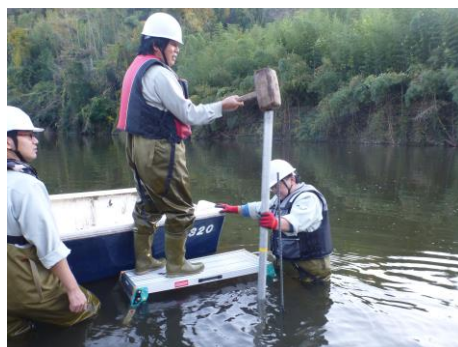
図-155 試験前 柱状サンプリング調査の状況
