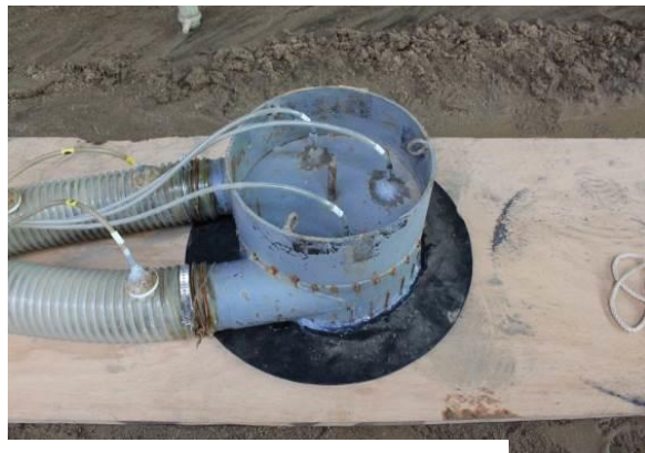
図-21 管径100mm模型吸引部 (吸引口7個, 管径50mm, 重量30kg)
