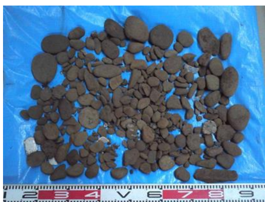
図-83 排砂口から排出された礫
