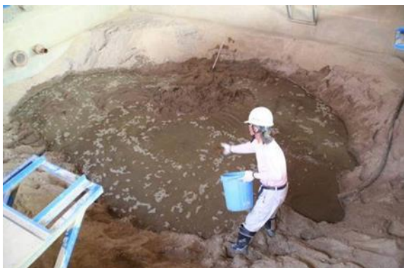
図-159 流木模型投入状況
