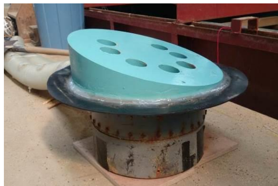
図-22 管径100mm模型吸引部 (改良形状)
