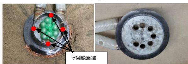
(直径300mm, 吸引口7個φ50mm, 重量30kg)
