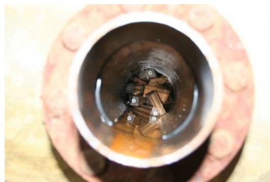
図-162 バタフライバルブ設置位置の流木模型の閉塞状況
