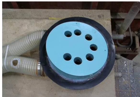
図-21 管径100mm模型吸引部 (吸引口7個, 管径50mm, 重量30kg)
