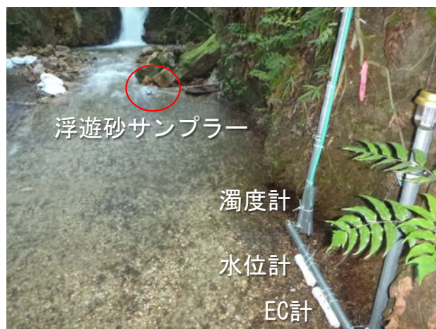
写真-1 観測機器設置状況（下流より撮影）
