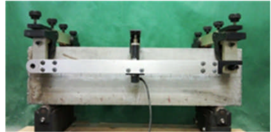
写真 5.2.1 曲げ供試体にたわみ測定器具を装着
