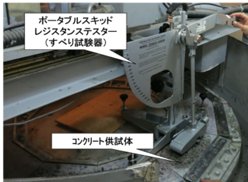
写真 5.6.1 すべり試験の状況
