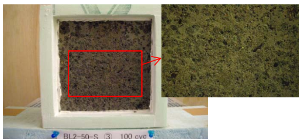
写真-12 スケーリング状況（100サイクル） （再生粗骨材のみ、水結合材比50%）
