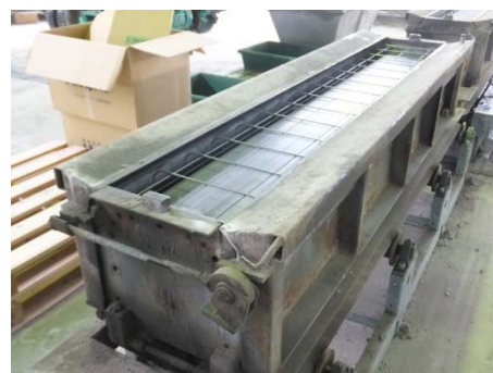
写真-10 振動締め固め機 (型枠が台ごと振動する)
