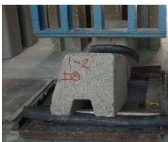
写真-7 曲げ強度試験状況
