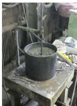
写真-5 コンシステンシー試験 (円柱容器が台とともに振動する)
