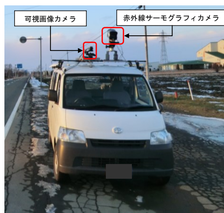
写真 3.3-1 赤外線カメラを搭載した調査車両
