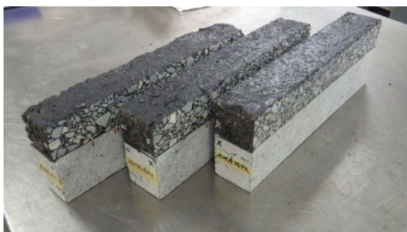
写真 4.4-6 防水工の損傷確認用供試体
