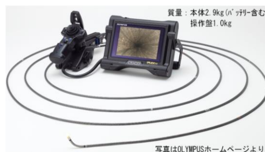
写真-3.2 使用した内視鏡カメラ
