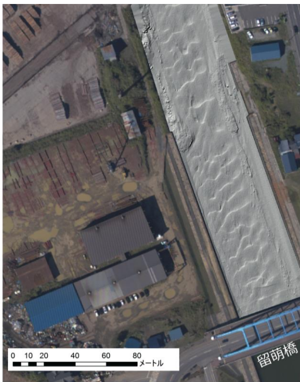
図 - 2.12 留萌開発建設部によるマルチビーム測量観測結果 (2011年12月14日) 標高値陰影図
