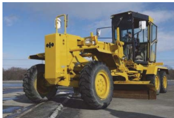
写真-4 モータグレーダ(3.1m級)
