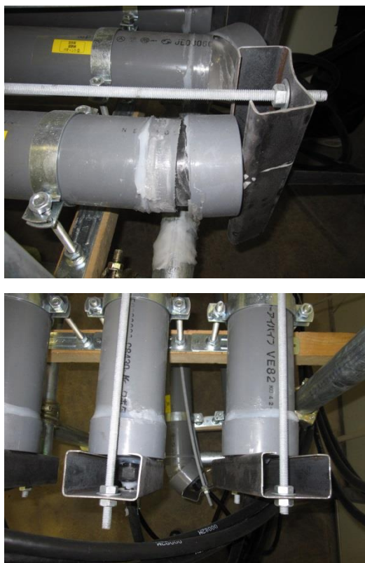
写真-8 凍結後の供試体蓋部 (上：満水 下：半水)
