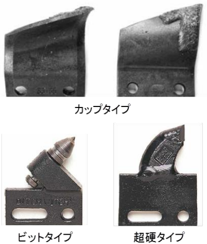
図-21 掘削刃の例
