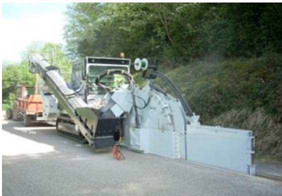
写真-12 ケーブル同時埋設および掘削土砂のベルトコンベア搬送機能を有した機械 ホームページより引用 11)
