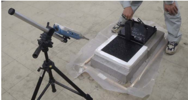
写真-1 ゴム板転倒試験状況
