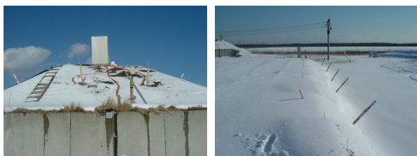
高さが2mののり面 高さが0mののり面 写真-6 高さの異なるのり面の積雪状態(12月27日)
