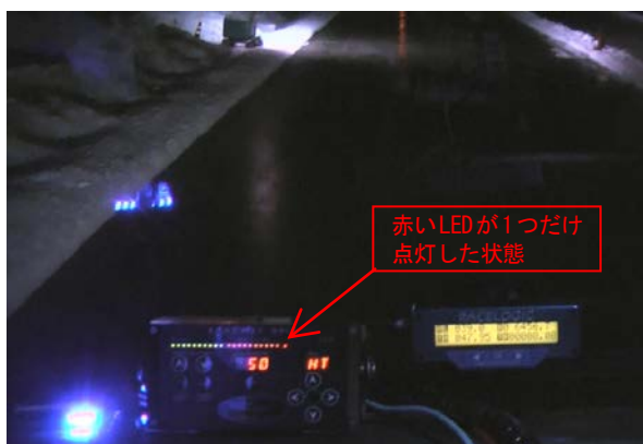
写真-6 試験状況(運転室内から CFT-UT 制御・表示器および前方路面を撮影)
