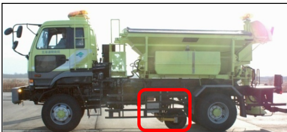
写真-1 CFT-UTを取り付けた凍結防止剤散布車 (赤枠の位置にCFT-UTを取り付け)
