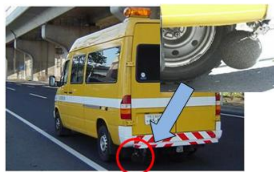
写真-6 舗装路面騒音測定車
