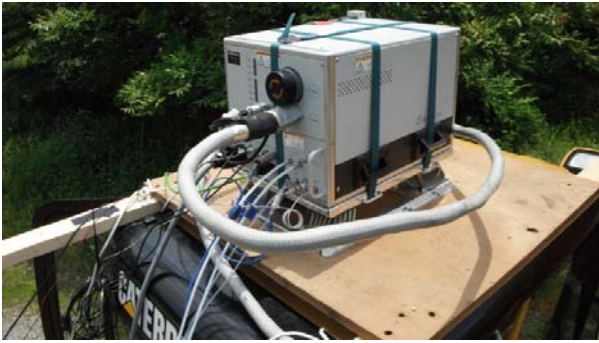
写真-2 車載型排出ガス計測装置の搭載状況
