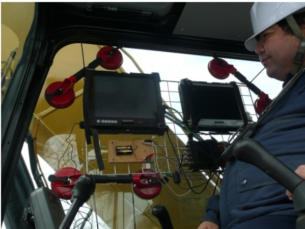
写真-3 運転室内に設置した PC 等の設置状況
