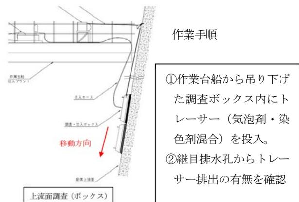
図-4.6 上流面からのトレーサー調査(トレーサー投入用ボックスを用いる例)
