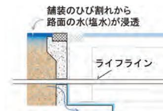
配管のためのパラベットの貫通孔を通じて土中水分が流出する可能性がある
