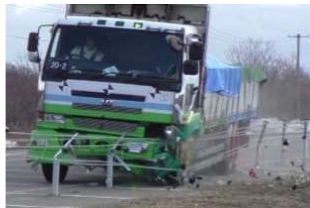
H23 ロープ連結材なし R02 ロープ連結材あり 前輪タイヤのロープ押し下げ(3本から0本に)防止に有効 最大進入行程: 1.48mから0.604mに低下
