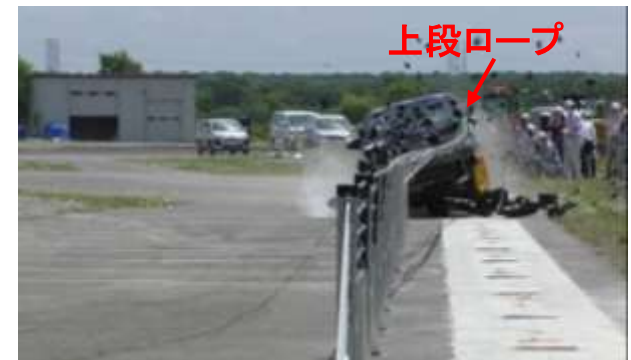
R02 ロープ連結材あり 上段ロープの押し上げ防止に効果を発揮
