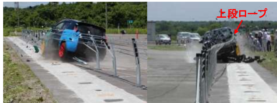
分離帯用Am種の衝突試験の状況(2020年7月)
