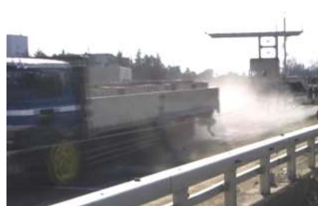
H23 ロープ連結材なし R02 ロープ連結材あり 前輪タイヤのロープ押し下げ(3本から0本に)防止に有効 最大進入行程: 1.48mから0.604mに低下
