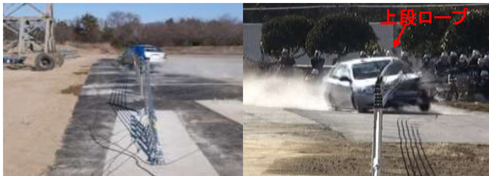
分離帯用Am種の衝突試験の状況(2012年1月)
