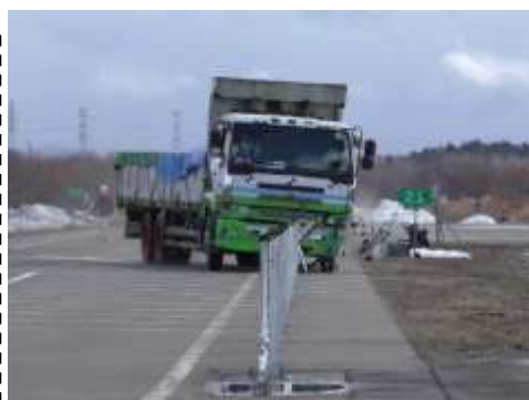
分離帯用Am種の衝突試験の状況(2019年3月)
