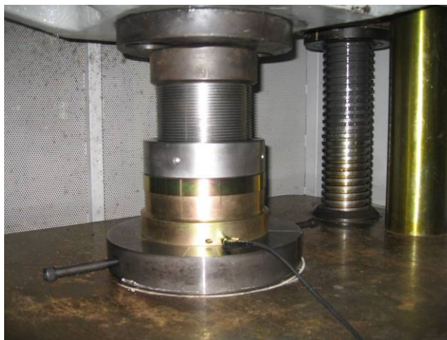
II : 専用の取付け治具による載荷
