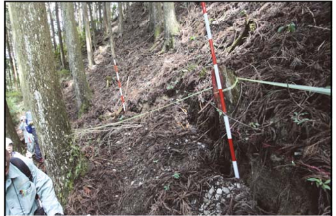
斜面上部で認められた、約100mにわたって連続する亀裂 開口幅20~30cm, 段差30cm程度 14
