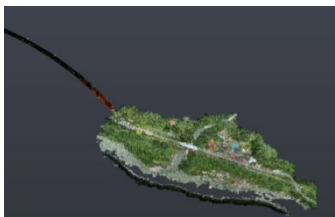
UAV・地上レーザによる点群データ
