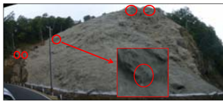
写真2.4.5 地震計による岩塊の安定性確認
