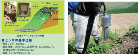
写真2.3.1 IT地盤傾斜計
