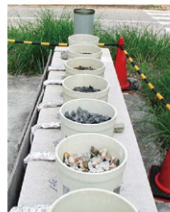
土研式雨水曝露試験
