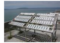
耐食試験の設置状況
