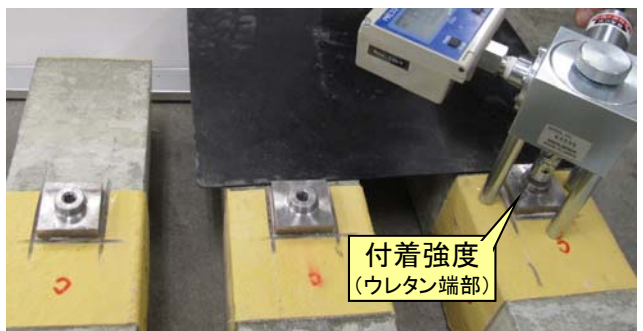
塩水浸漬及び凍結融解試験の後の附着強度を測定
