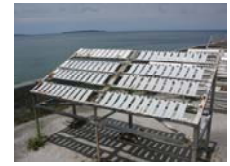
耐食試験の設置状況
