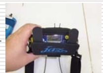
光源・検出器・モニター・バッテリーが一体となった可搬型計測器
