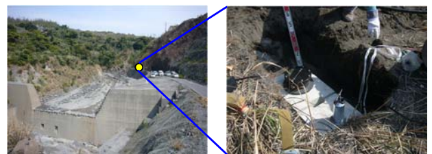
溪岸に振動を観測できるセンサーを設置する。土石流が発生する地盤振動をとらえて検知する。
