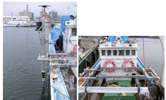
架装装置、艀装用架台を取り付けた状態
