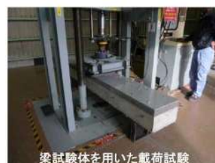
梁試験体を用いた荷重試験
