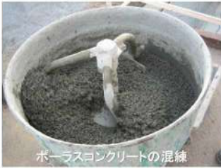
ポーラスコンクリートの混練
