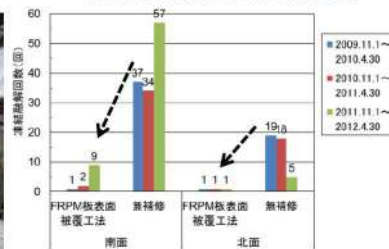
FRPM板で補修した場合と無補修の場合の水路躯体コンクリートの凍結融解回数※3
