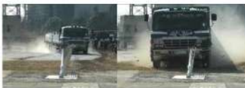
大型車の防護柵衝突後の軌跡(2012年1月)
