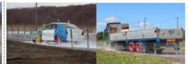
分離帯用Am種の衝突試験の状況(2016年3月, 8月)
