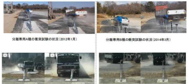
大型車の防護柵衝突後の軌跡(2012年1月)
