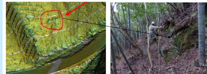
斜面上の不陸箇所や急崖は露頭の可能性がある
