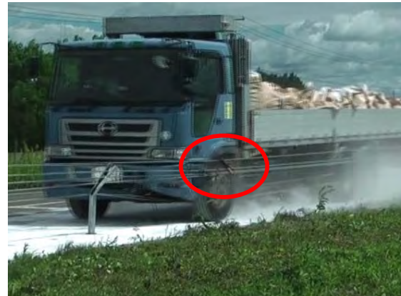
車両衝突時においても飛散しない
