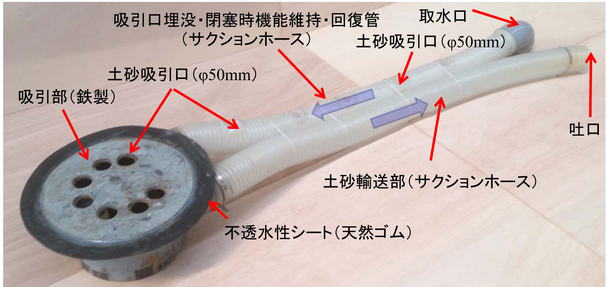
φ100mm潜行吸引式排砂管(吸引口径50mm:裏返した状況)
