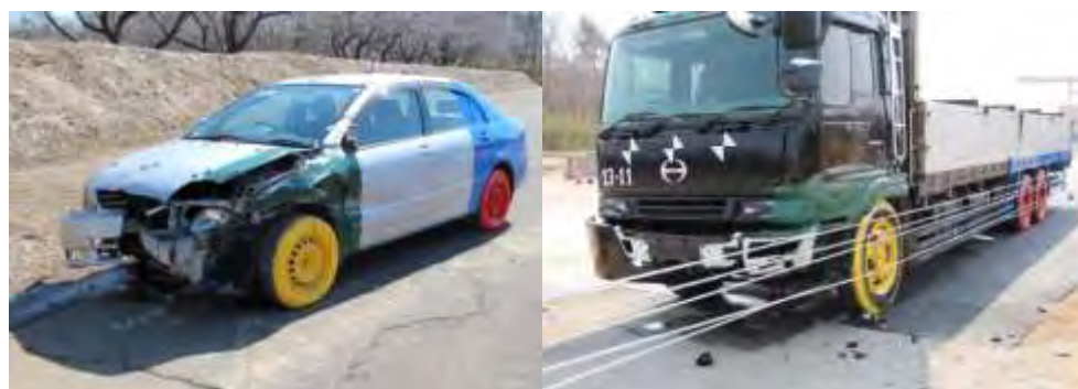
衝突後の乗用車と大型車の破損状況(2014年3月)
