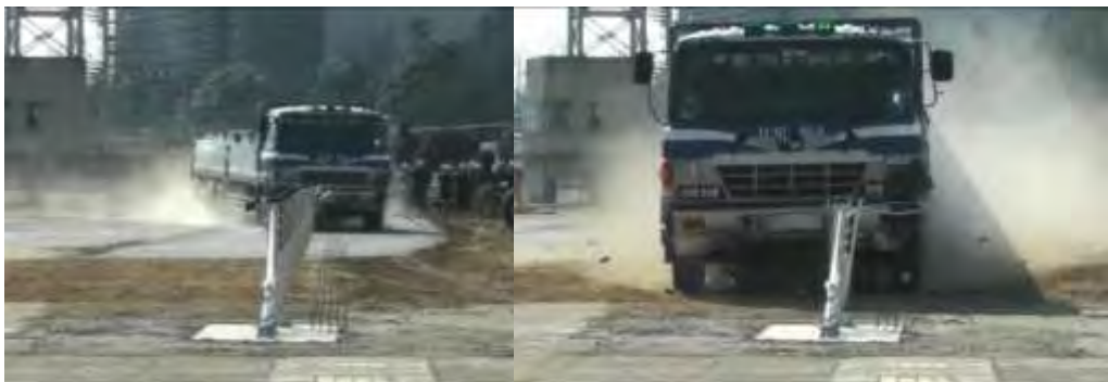
大型車の防護柵衝突後の軌跡(2012年1月)
