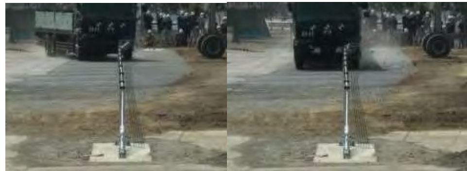
大型車の防護柵衝突後の軌跡(2014年3月)
