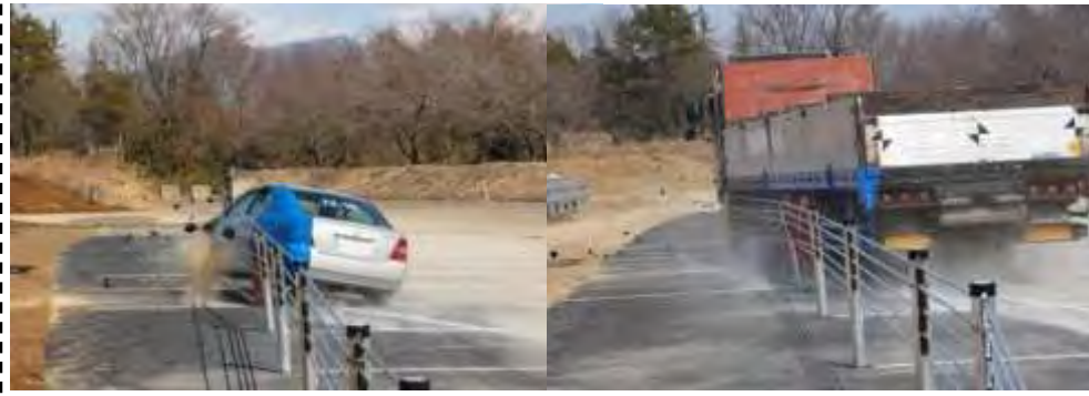
分離帯用B種の衝突試験の状況(2014年3月)
