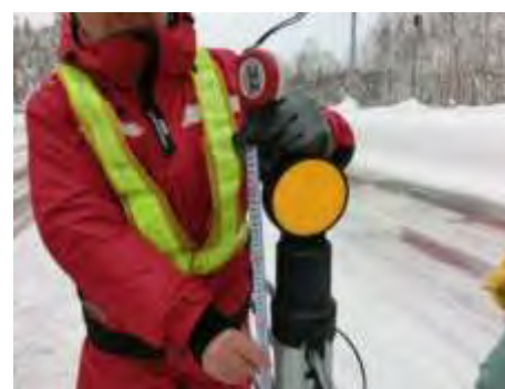
取付け高さ1.2m
