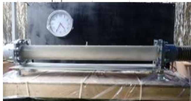
土砂濃度計測装置(自動化)
