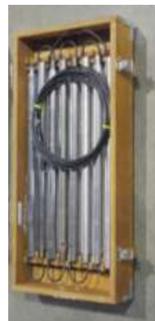
貫入式間隙水圧計(4m)
