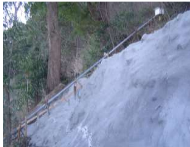
地盤伸縮計による地すべり監視
