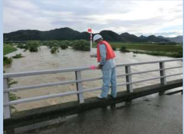
洪水時の流量観測(高水流観)
