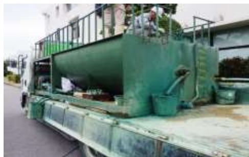
吹付工用ポンプ車
