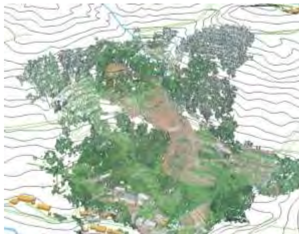
地すべり災害対応の BIM/CIMモデル
