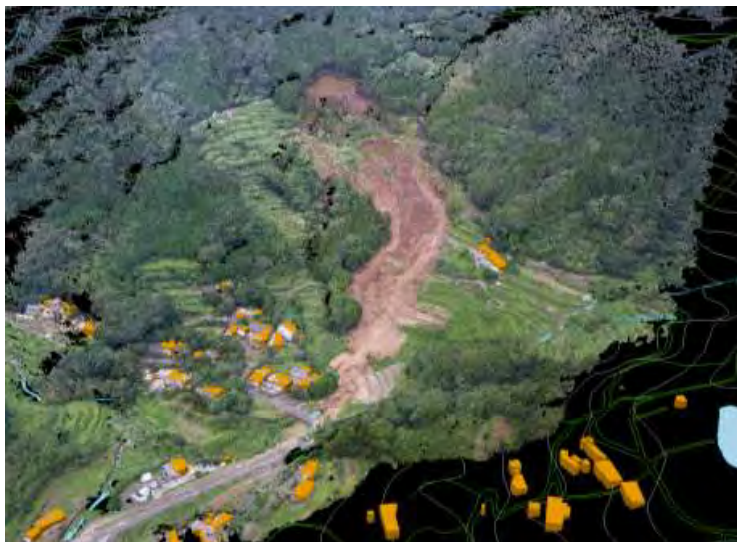
地すべり災害対応のBIM/CIMモデル
