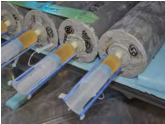
割裂ひび割れを入れた φ10×20cm円柱供試体に 樹脂系注入材を注入
