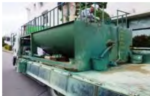
吹付工用ポンプ車
